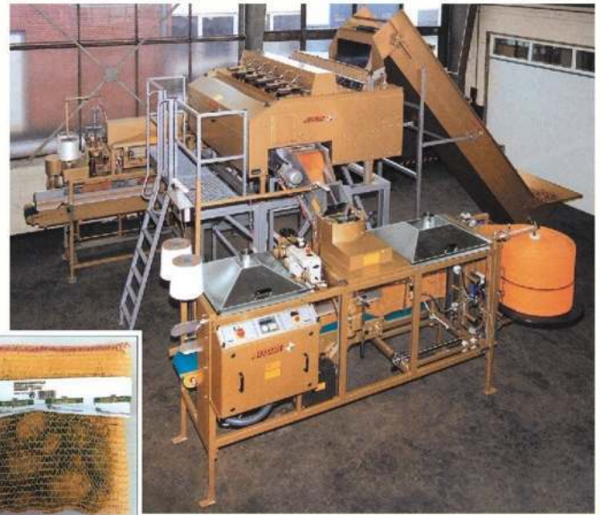
Πλήρως αυτόματη γραμμή ζύγισης-συσκευασίας φρούτων σε δίχτυ-κουπάκια και σακούλες PVC Fully automatic weighing line for fruit in net-punnets-PVC
